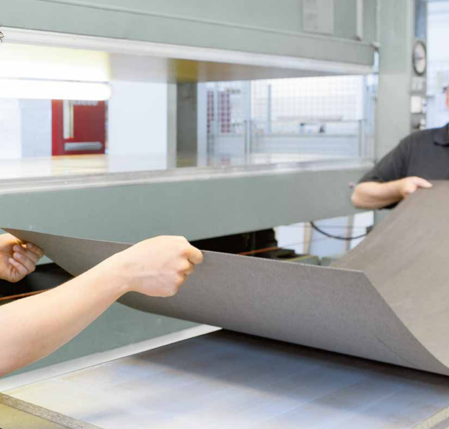
Ein Furnierblatt wird in reiner Handarbeit sorgfältig auf die Frontplatte aufgebracht. A sheet of veneer is applied entirely by hand to the front.
